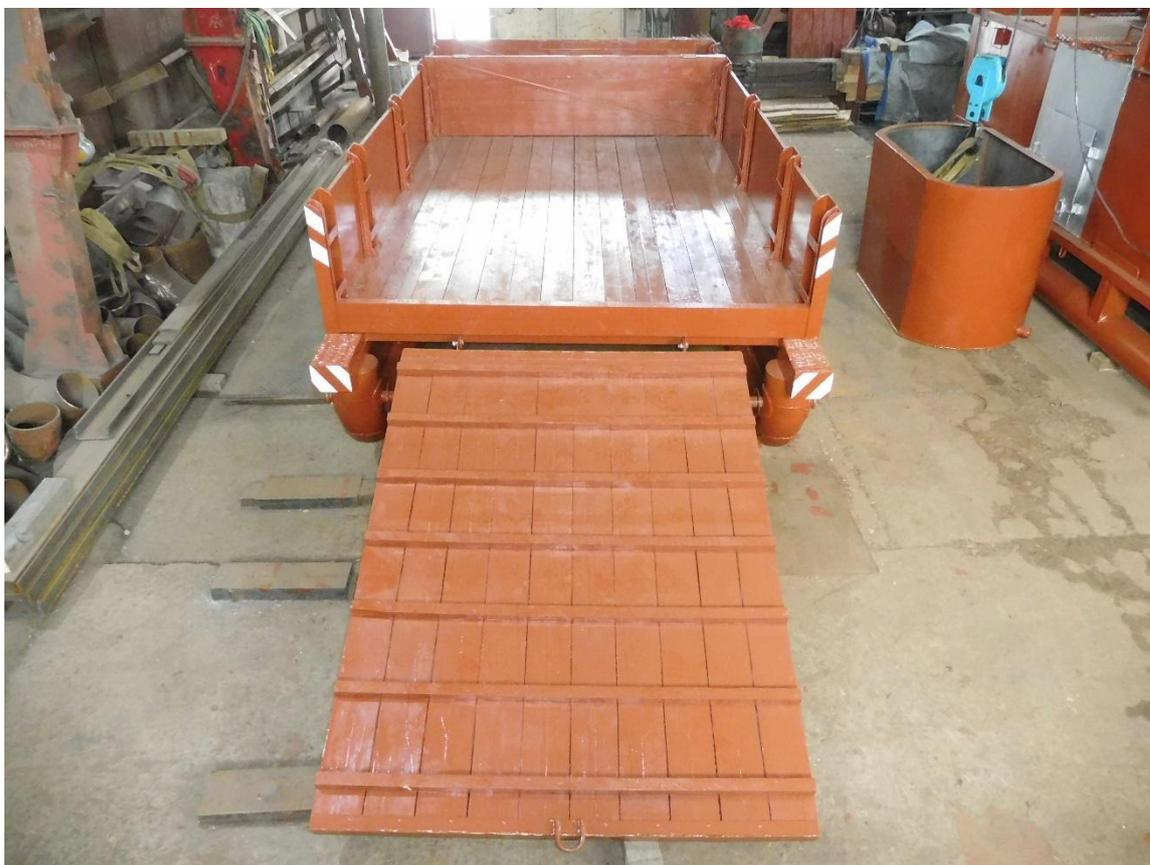
Собственная разработка ДТХЗ представляет собой конструкцию санного основания, предназначенную для транспортировки буровых труб  $L=3$  м (в отсеке  $3,10 \times 2,10$  м) с дополнительным ящиком (коробом  $2,10 \times 0,68$  м) под буровой инструмент.
