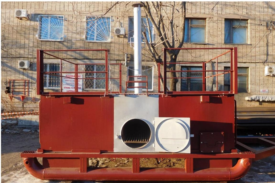
Рабочие габариты в собранном виде (с ограждением):  $4,00 \times 2,20 \text{ м}$  ( $H=2,30 \text{ м}$ )
