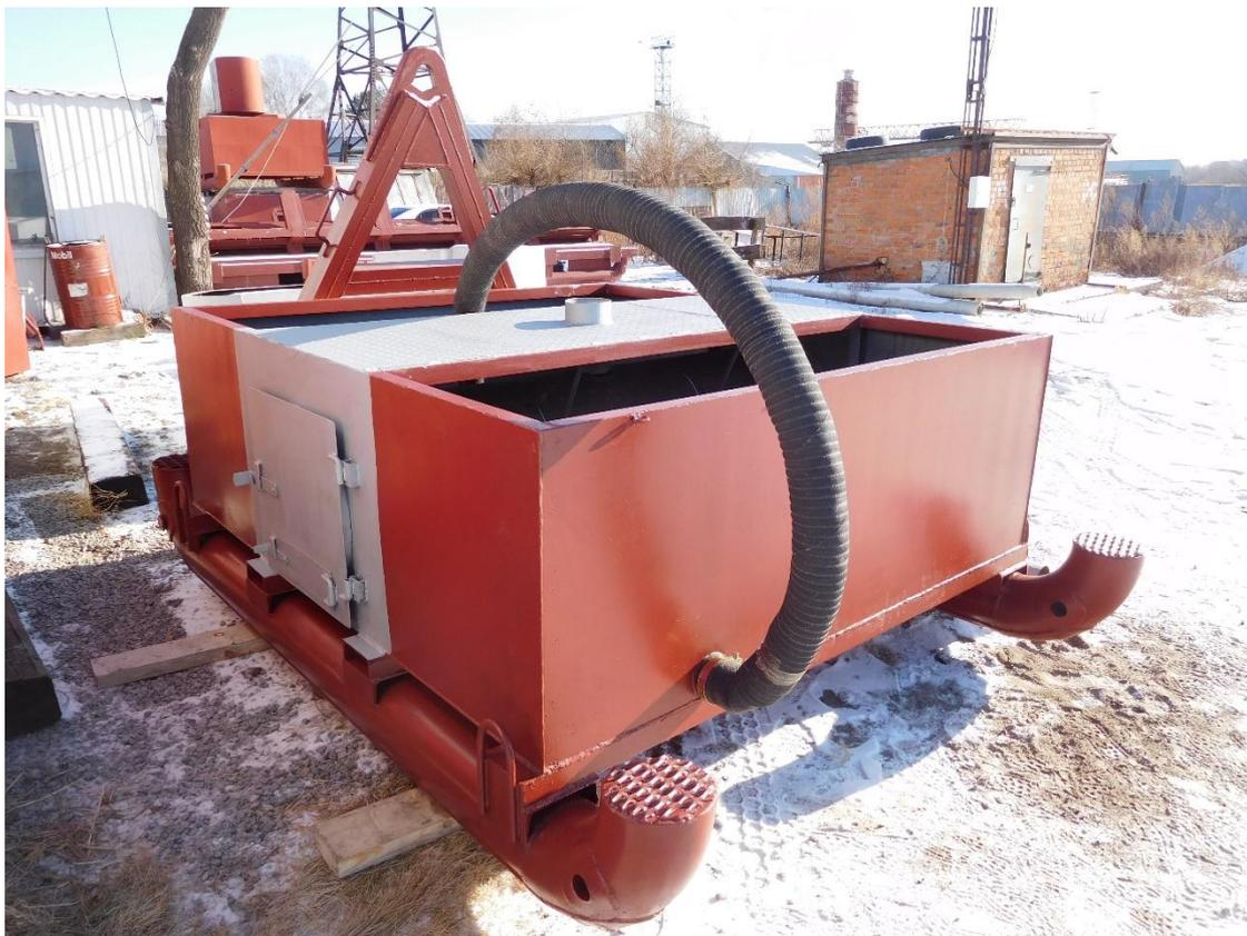
Ёмкость в нижней части имеет два сгона (с торцевых сторон в противоположном направлении) с напорно-всасывающими рукавами  $\text{Ø}100 \text{ мм}$  для перекачки буровых жидкостей. Верхняя часть частично зашита металлическим листом (рифлёный лист над печкой).
